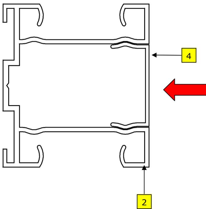
Possibilità di chiudere temporaneamente la predisposizione con il profilo di chiusura
